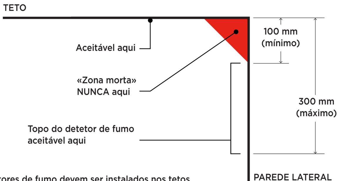
Os detetores de fumo devem ser instalados nos tetos ou perto dos tetos e não numa zona morta
